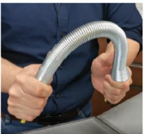
Para dobleces de tubería a más de 90°, utilice el resorte doblador. Introduzca el resorte en la tubería, sujete los extremos y proceda a hacer el doblez hasta el ángulo deseado, respetando un radio mínimo equivalente a 5 veces el diámetro exterior de la tubería utilizada.
