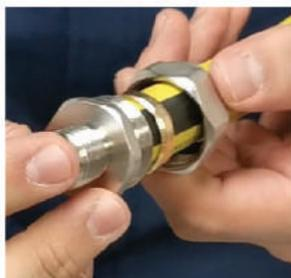
Inserte la conexión dentro de la tubería y ensamble los componentes, apriete manualmente la contratuerca hasta el tope y posteriormente, apriete la conexión girando  $\frac{1}{2}$  vuelta más con ayuda de un par de llaves ajustables.
