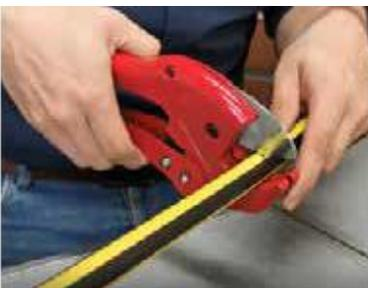
Mida la distancia requerida y realice un corte recto en la tubería, es esencial que el corte sea realizado con las tijeras suministradas por Coflex. No utilice otro tipo de herramientas,
