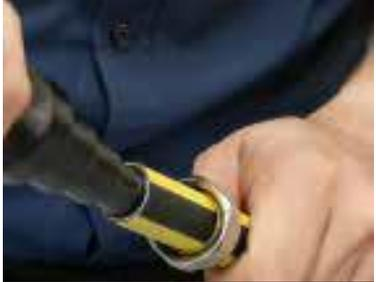
Inserte el avellanador en la tubería hasta que tope y gírelo, al menos, 3 veces en la misma dirección para lograr un rectificado en la circunferencia, y al mismo tiempo, biselar el interior de la tubería para realizar un ensamble correcto con la espiga y o-rings de la conexión.
